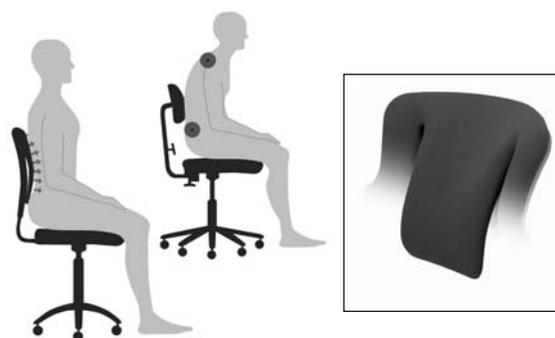
Специально сконструированный выступ в спинке позволяет сохранить правильное положение сидящего в любом положении, под любым углом, т.к. отклоняется и придвигается в зависимости от нагрузки. Благодаря динамической поддержке поясничной области спины нагрузка на позвоночник снижается, нагрузка на поясницу распределяется равномерно, осанка улучшается.
